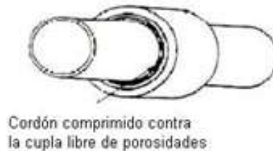
Figura 7 - Aspecto de un cordón de fusión a enchufe correctamente conformado
