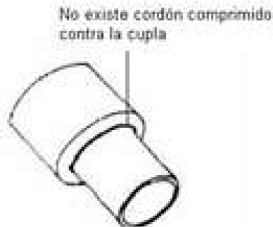
Figura 9 - Cordón deficiente, el material fue arrastrado por la herramienta calefactora hacia el interior de la cupla.
